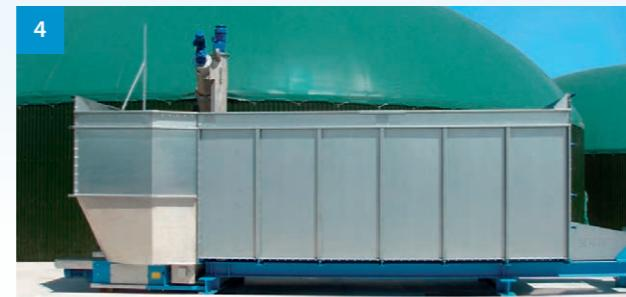
**Feststoffeintrag Schubboden** · Moving floor container · Entrée de matières solides dans un doseur à fond mouvant · Alimentatore a fondo mobile per matrìci solide · Dosificación con fondo empujón · Дávkoвáč s posuvnou podlahou · Передвигающийся напольный контейнер
